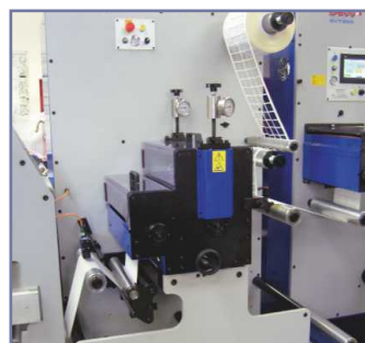
Daco DM350 rotary die cutting module
